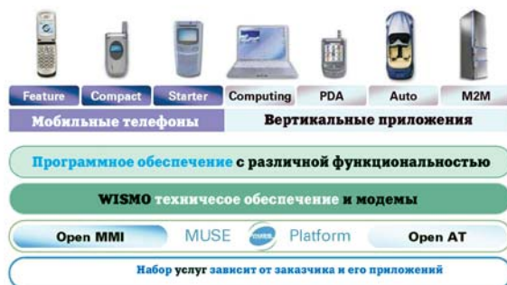
Рис. 5. Структура аппаратно-программного комплекса WOW
